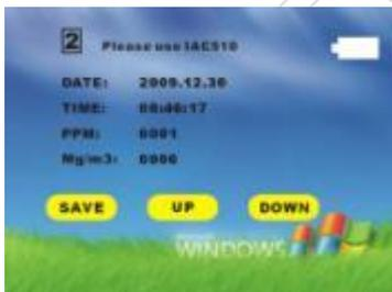
轻触 SAVE 键,功能显示为 2 时,可对存储数据进行历史查询,按 UP 键是查询上一个存储记录,按 DOWN 键查询下一个存储记录。
