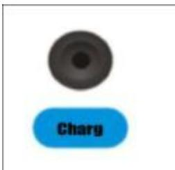
将充电器的插孔端插入仪器主机的〔Charg〕孔位，确认连接好后，将充电器的插座端连接 220V 电源。主机显示屏上则会出现电池电量不断增加减少表示正常充电，充电完成后则电池电量显示绿色满格。若电量剩余很少，则主机显示屏上的电池图象呈现红色提示。每次电量饱合时可连续工作 10 小时。
