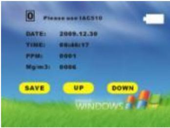
开机后,主机上正常显示如左图:显示功能为0,在枪柄与主机的显示屏上均可显示:时间、PPM值(体积浓度) $\text{mg}/\text{m}^3$ (质量浓度)。现国际通用标准为PPM(体积浓度),根据中华人民共和国的标准为 $\text{mg}/\text{m}^3$ (质量浓度)。
