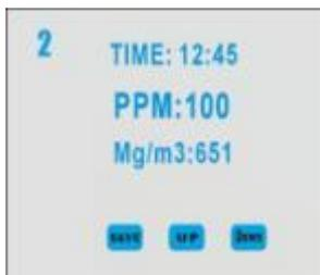
按 SAVE 键，功能显示为 2 时，可对存储数据进行历史查询，按 UP 键是查询上一个存储记录，按 DOWN 键查询下一个存储记录。
